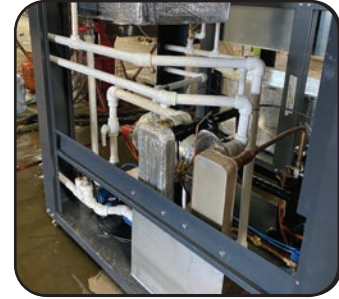
Yüksek Debili Santrifüj Pompa Plakalı Tip Evaporatör High Flowrate Centrifugal Pump Plate Type Evaporator
