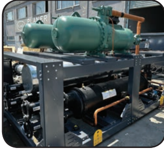
Vidalı Kompresör Screw Compressor
